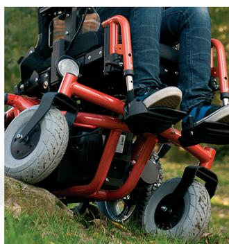
*Palonnier articulé à l'avant permettant le contact au sol des roues malgré des dénivelés importants*
